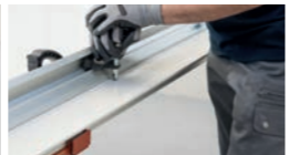
Guida da taglio con carrello incisore per tagli fino a 320 cm lineari e diagonali.
