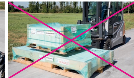
IT Per preservare l'integrità delle lastre non sovrapporre volumi diversi sulle casse. EN To prevent damage to slabs, do not stack items of different sizes on top of the crates.
