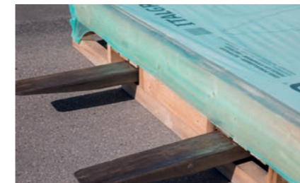
IT Per movimentare correttamente il pallet sul lato lungo si raccomanda di allargare al massimo le forche e di posizionarle al centro del pallet, far presa su tutta la profondità prima di sollevare. EN For correct handling of the pallet on the long side, the forks must be widened to their maximum setting and placed in the centre of the pallet; ensure contact through the entire depth before lifting.
