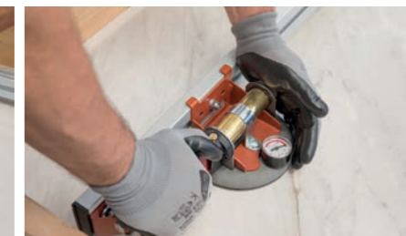
IT 2_Prima della movimentazione accertarsi che le ventose siano fissate e aderiscano perfettamente alla lastra. EN 2_Before handling, ensure that the suction cups are adhering firmly to the slab.
