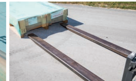
IT Per movimentare correttamente il pallet sul lato corto (ad esempio nello scarico dei containers) è raccomandato l'utilizzo di forche lunghe almeno 2,5 mt, questo garantisce una perfetta presa e sicurezza del materiale. EN For correct handling of the pallet on the short side (e.g. when unloading containers), forks at least 2.5 metres long should be used to ensure that the material is held perfectly and safely.
